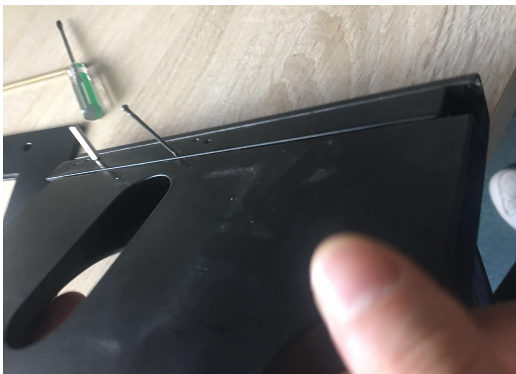
在平台底部找到 Y 轴的限位孔取下螺丝才可以分离 XY 轴
