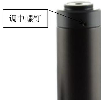
如果 CCD 工业相机靶面中心与其 C 型接口中心不重合，将导致变倍过程中像面中心产生移动。调整方法：将倍率转至最低倍 0.7X，在标本中指定一个点作为成像目标，移动标本使指定的目标成像在显示屏中心(见图 a)，然后将倍率缓慢转至高倍，观察并记住目标点移动方向(见图 b)；将倍率转至低倍，将标本沿相反方向移动(见图 c)，再重复上述操作，直至指定的目标点相对显示屏不产生移动。然后松开调中螺钉（三颗），调整 CCD 接筒的中心，将此目标点的像调至显示屏的中心并与实物方位一致(见图 d)，逐渐止紧螺钉三颗，直到螺钉完全止紧而变倍过程中像面中心不移动为止。其示意图如下：
