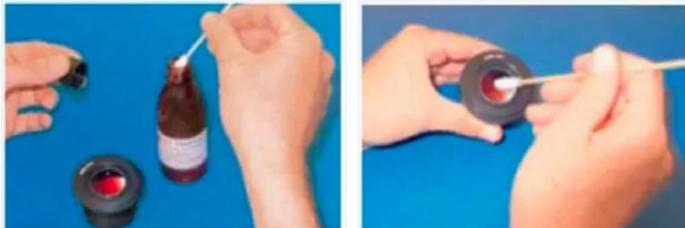
清洗时， 可以采用螺旋清洗的方式，从中心逐步到边缘。一定不要用“之”字形的方式清洗，因为这样而会将污渍范围扩大。对于大一些的光学面（如，镜筒镜头）可以先将清洗周边，然后再从中心螺旋式清洗至边缘。一般推荐多做几次这样的螺旋式清洗。
