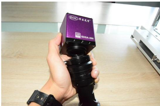
5、将镜头与相机安装至升降组上（箭头指向为固定镜头位置螺丝）
