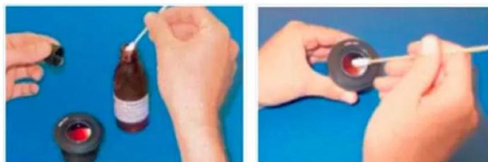
清洗时， 可以采用螺旋清洗的方式，从中心逐步到边缘。一定不要用“之
