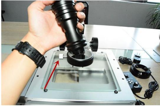
6、安装光源（红色箭头指向位置为光源紧固螺丝，蓝色箭头指向位置为光源紧固螺丝的固定位置，黄色箭头指向位置为 3D 装置与镜头连接的位置）
