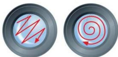
用螺旋式清洗，而不要用“之”字形清洗方式
